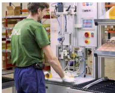
Vzduchový test na montážnej linke.
