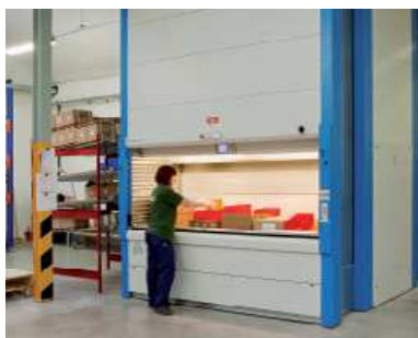
KARDEX. Veľkokapacitný automatizovaný skladovací systém.
