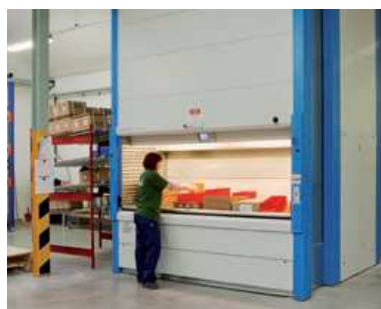
KARDEX. Veľkokapacitný automatizovaný skladovací systém.
