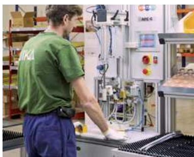
Vzduchový test na montážnej linke.
