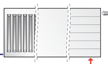
↑ - napájací vodič ↓ - spätný vodič
