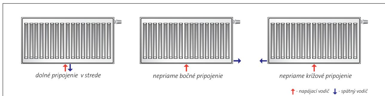
↑ - napájaci vodič ↓ - spätný vodič
