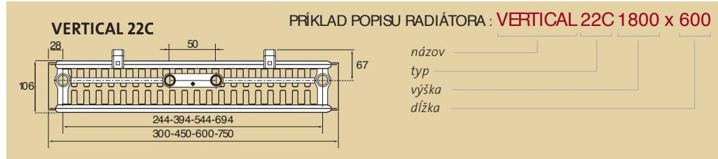
Pre radiátor Vertical 22C sú pripojenia asymetrické vzhľadom na panely radiátora
